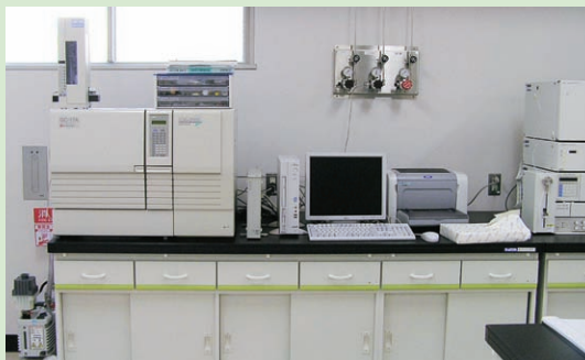
食品の匂い成分の分離・同定に用いられるガスクロマトグラフィー質量分析計
