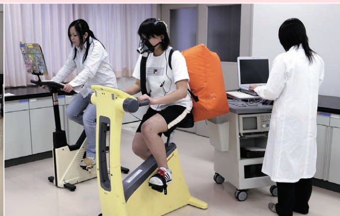
栄養生化学実験1(ダグラスバッグに呼気を集めてエネルギー消費を求め実験)
