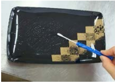
図 3. ATP ふき取りキットによる食器残留物の検査の様子
