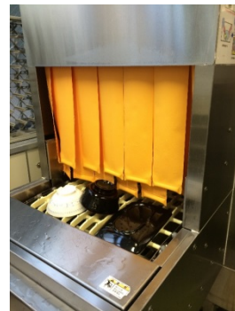
図7. コンペア式食器洗浄機
