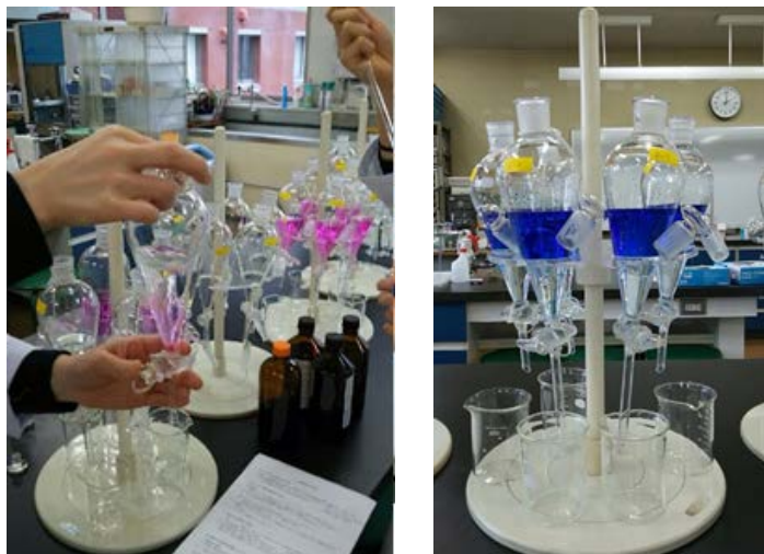
図5. 食器の洗剤残留試験〈メチレンブルー法〉の様子
